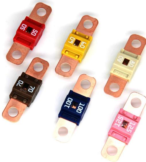
电力电路及大功率设备所使用的保险丝，不仅有一般保险丝的三个部分，而且还有灭弧装置，因为这类保险丝所保护的电路不仅工作电流较大，而且当熔体发生熔断时其两端的电压也很高，往往会出现熔体已熔化（熔断）甚至已汽化，但是电流并没有切断，其原因就是在熔断的一瞬间在电压及电流的作用下，保险丝的两电极之间发生拉弧现象。这个灭弧装置必须有很强的绝缘性与很好的导热性，且呈负电性。石英砂就是常用的灭弧材料。另外，还有一些保险丝有熔断指示装置，它的作用就是当保险丝动作（熔断）后其本身发生一定的外观变化，易于被维修人员发现，例如：发光、变色、弹出固体指示器等。保险丝未来会有怎样的发展方向？山西汽车系列保险丝
