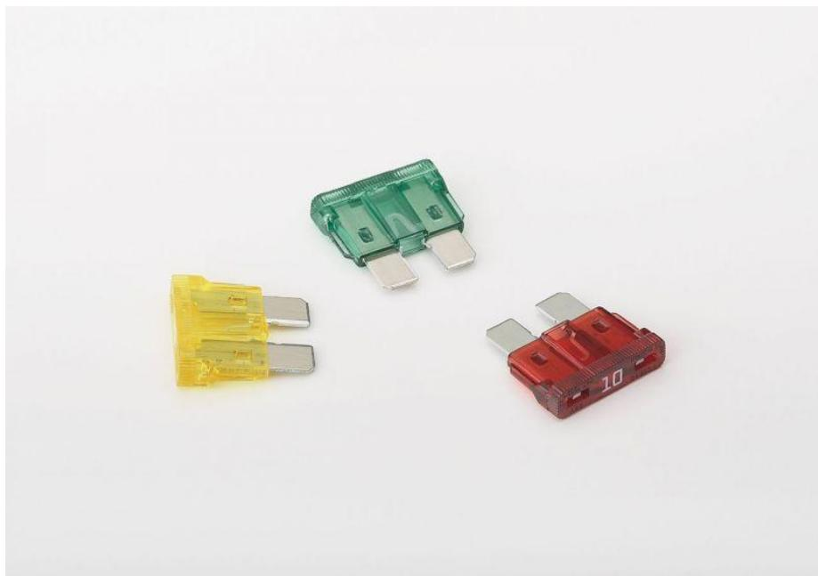
当电流通过导体时，因导体存在一定的电阻，所以导体就会发热，制作保险丝的材料和形状确定后，其电阻也就确定了，当电流流过它时，它就会发热，随着时间的增加其发热量也会增加，电流和电阻的大小确定了产生热量的速度，保险丝的结构与其安装的状况确定了热量消耗的速度，若产生热量的速度小于热量消散的速度时，保险丝就不会熔断。保险丝的作用是，当电路发生故障或异常时，伴随着电流不断升高，并且升高的电流有可能损坏元器件，也有可能烧毁电路甚至造成火灾。如果电路中安装了保险丝，它会在电流异常升高到一定高度的时候，熔断保险丝从而切断电流，起到保护电器的作用。山西汽车系列保险丝保险丝所设计的产品有哪些？
