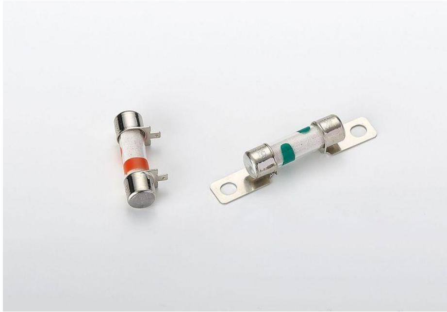
一般保险丝由三个部分组成：一是熔体部分，它是保险丝的，熔断时起到切断电流的作用，同一类、同一规格保险丝的熔体，材质要相同、几何尺寸要相同、电阻值尽可能地小且要一致，重要的是熔断特性要一致，家用保险丝常用铅锑合金制成；标志标志大多数保险丝的标记在身上或端盖与标记，指示其评级。但是“芯片类型”保险丝功能很少或没有标记，使识别非常困难。保险丝可能出现类似的不同的特性，确定了它们的标记。保险丝标记通常会传达以下信息：安培的保险丝的额定电压等级的保险丝时间-电流特性，即速度保险丝批准由国家和国际标准机构制造商/产品编号/系列中断能力作用一百多年前由爱迪明的保险丝用于保护当时昂贵的白炽灯，随着时代的发展，保险丝保护电子/电力设备不受过电流/过热的伤害，避免电子设备因内部故障所引起的严重伤害。
